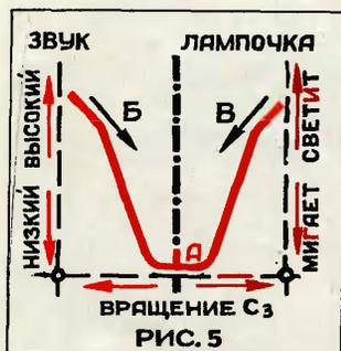
Понемногу (очень плавно) поверните ручку настроечного конденсатора  $C_3$  до появления в телефоне свиста. При дальнейшем (тоже
