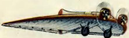
1934 год. Построен первый двухмоторный самолет БИЧ-14 — бесхвостая машина с параболическим крылом в плане.
