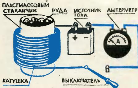
**СОЛЕНОИД-КОНТРОЛЕР.** Я предлагаю прибор для определения процентного содержания металла в руде. Принцип действия его основан на том, что при внесении в магнитное поле железного сердечника изменяется магнитный поток. Прибор состоит из катушки (соленоида), источника тока, амперметра и пластмассового стаканчика, вставляемого внутрь соленоида. Наполнив стаканчик рудой, включаем прибор. Чем больше содержится металла в руде, тем сильнее изменятся показания амперметра.
